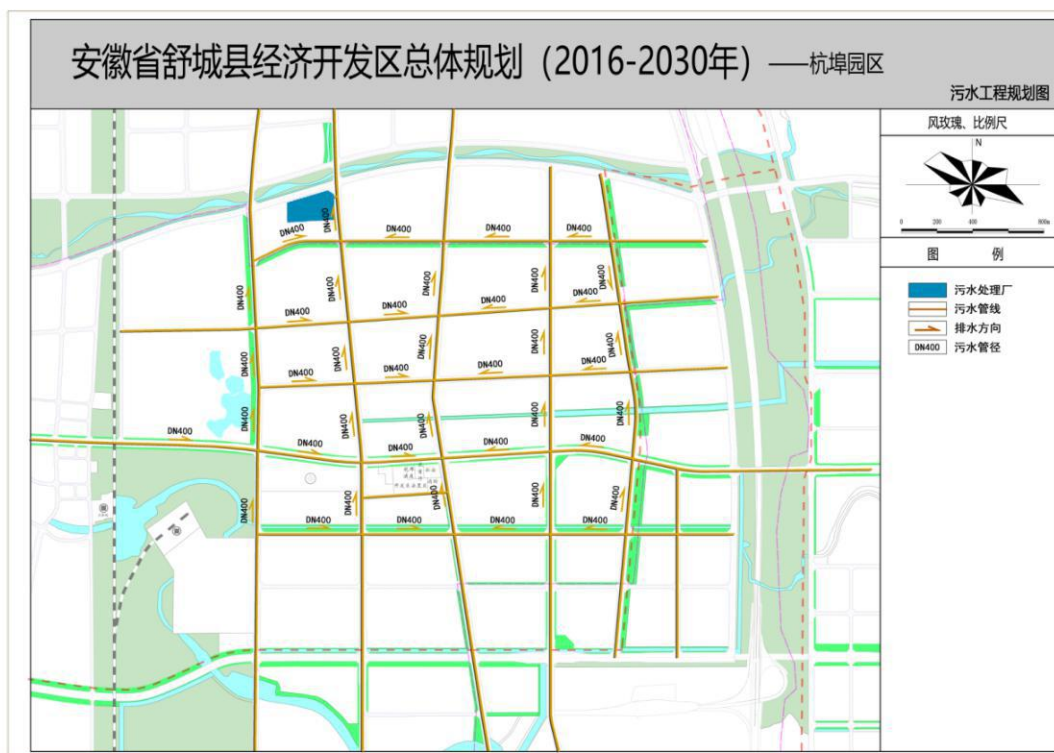
图 1.2.6-4 杭埠园区污水管网图
