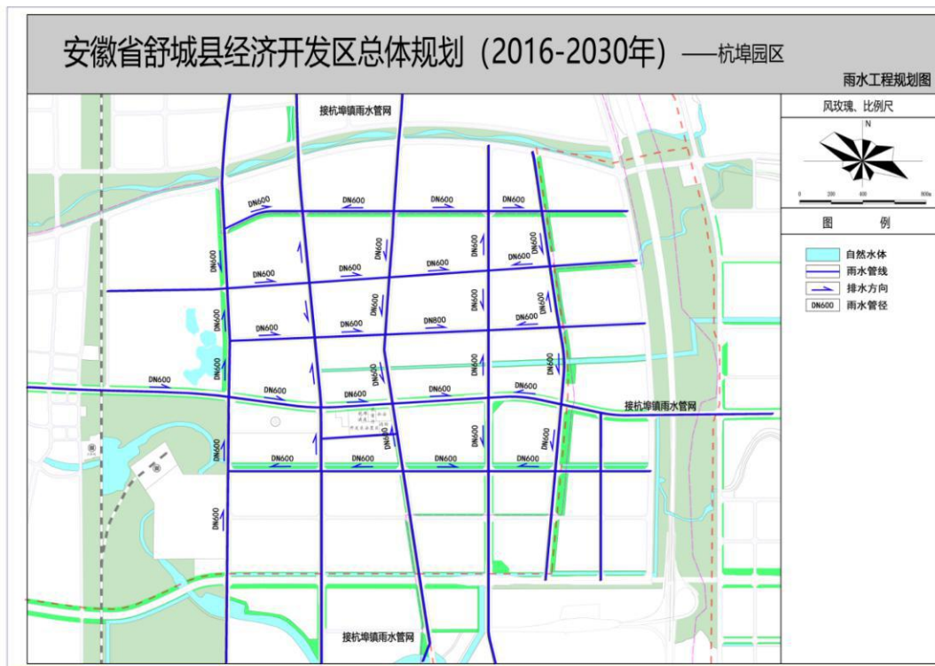
图 1.2.6-3 杭埠园区雨水管网图
