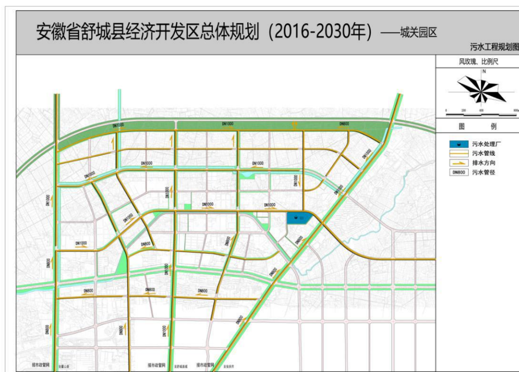
图 1.2.6-2 城关园区污水管网图
