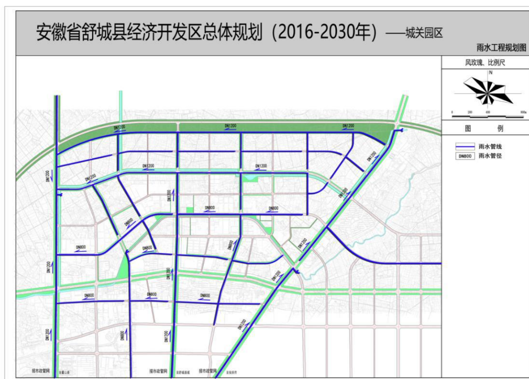
图 1.2.6-1 城关园区雨水管网图
