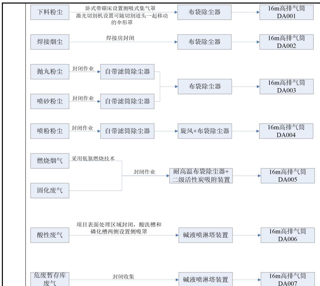
图 4-2 项目废气处理工艺流程图
