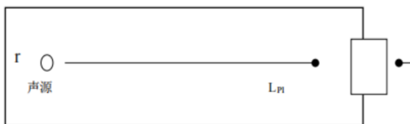
图 4-1 室内声源等效为室外声源图例
