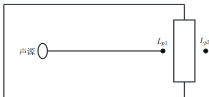
图 4-4 室内声源等效为室外声源图例
