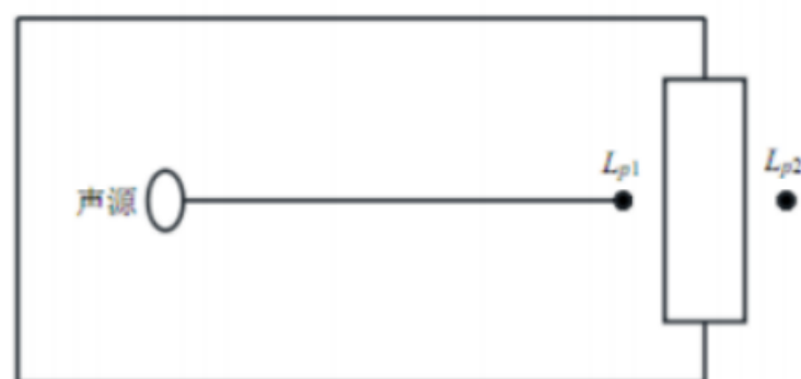
图 4-4 室内声源等效为室外声源图例
