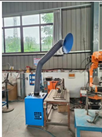
焊接废气收集
