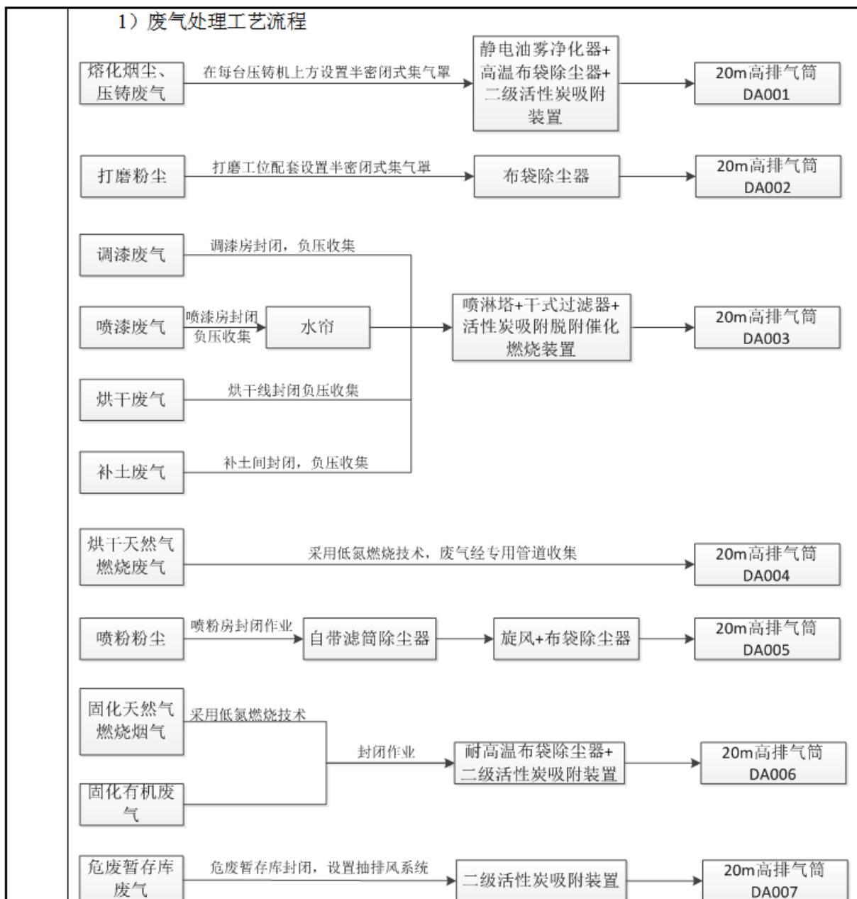
图 4-4 项目废气治理流程图
